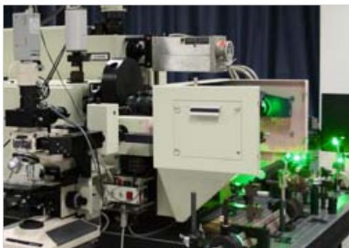
Un spectromètre T64000 Jobin Yvon est couplé avec un microscope confocal olympus. La source d'excitation est un laser à argon ionisé spectra physics (raies principales à 514.5, 488, 457.9 nm). Cet outil équipé de trois réseaux de diffraction et d'un détecteur CCD refroidi à l'azote liquide est le plus polyvalent du marché avec la possibilité :
