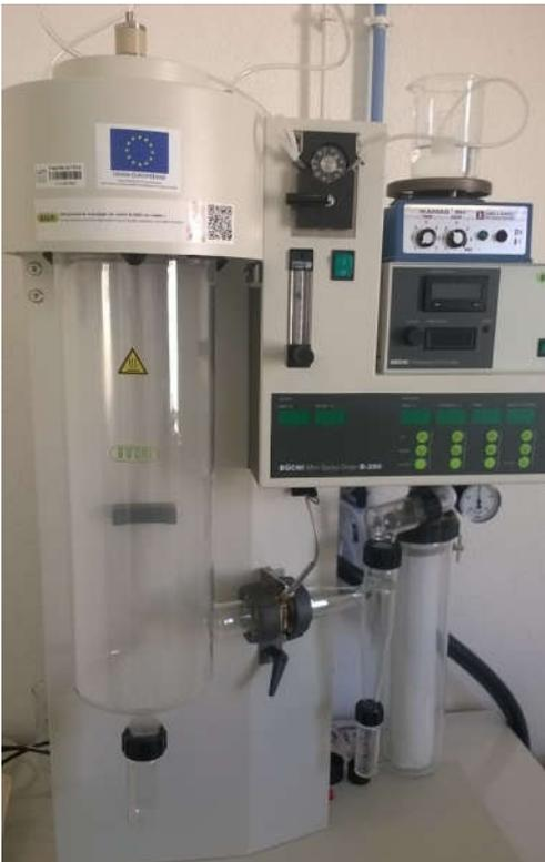
L'atomiseur de séchage permet la production de poudres micrométriques avec une distribution de taille très étroite, à partir de suspensions aqueuses, par pulvérisation et séchage dans un flux d'air (technique de « spray drying »).
