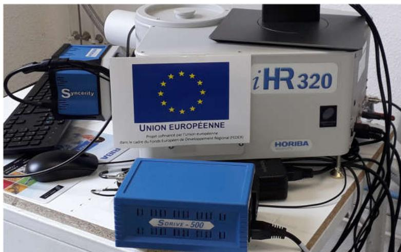
L'analyse du plasma par spectroscopie optique d'émission (SOE) nous permet d'identifier certaines espèces présentes dans la phase gazeuse et ainsi de comprendre ensuite l'interaction plasma-poudres.
