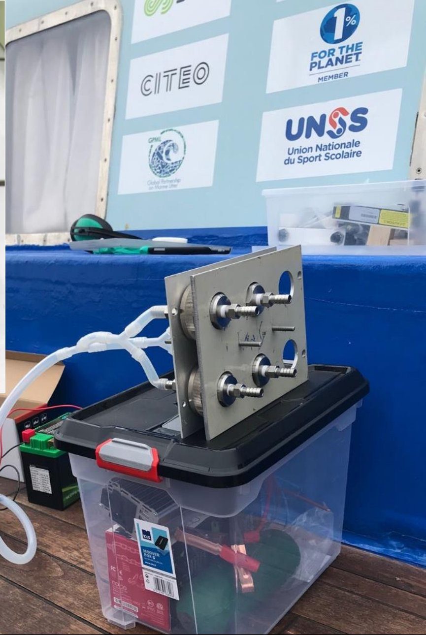
Echantillonneurs d'aérosols longue durée et installation sur le bateau pour la campagne Atlantys
